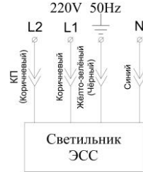
Светильник с аварийным режимом L1- основное питание L2 -контроль присутствия U (подключать от эл. сети 220В фаза)
